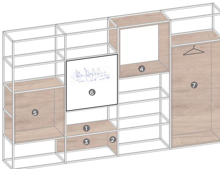
El panelado está formado por tableros de melamina de 19 mm. de espesor, con los cantos de 1 mm. y por un herraje de unión de poliamida con fibra de vidrio que se empotra en el perfil de acero. Estos herrajes van colocados en 2 de los cantos del panel, siendo estos cantos paralelos. El montaje se realiza sin necesidad de herramienta.
